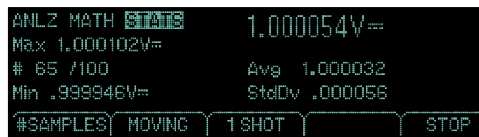
Obr. 2 Fluorescenční displej nových multimetrů Fluke
