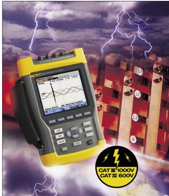
Obr. 2. Fluke 430 je odolný proti přepětí
