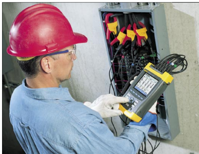
Obr. 3. Přímé měření proudů na fázích a nulovém vodiči
