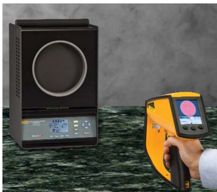
Správná kalibrace vyžaduje dostatečnou velikost kalibračního terče.
