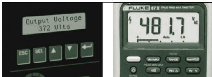
Obr. 3. Znárodnění rozdílů mezi zobrazením na regulátoru a hodnotami naměřenými multimetrem bez filtru
