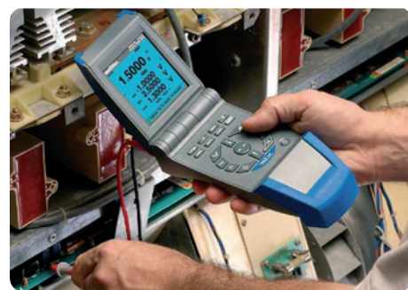
Obr. 3 MTX 3280 zobrazuje kromě hlavního údaje také statistiky
