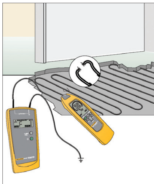
Obr. 7. Metoda dvou vysílačů při hledání přerušeno topných kabelů v podlaze
