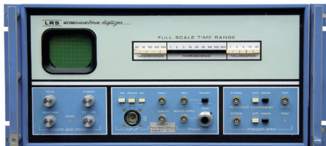
Obr. 2 I dnes plně funkční digitizér WD-2000 z produkce LeCroy Research Systems s rychlostí 1 GS/a, rok 1971
