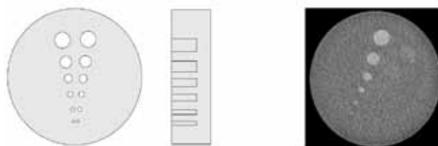
Obr. 6. Schéma a expozice části fantomu pro měření rozlišení při nízkém kontrastu
