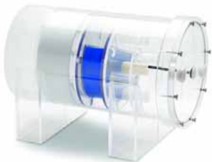
Obr. 1. Fantom pro komplexní ověření CT zařízení při zkouškách provozní stálosti.
