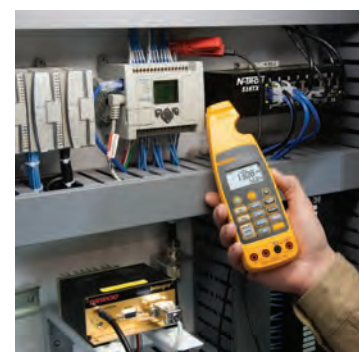
Měření, zpracování a další automatizace signálů 4–20 mA bez přerušení smyčky.
