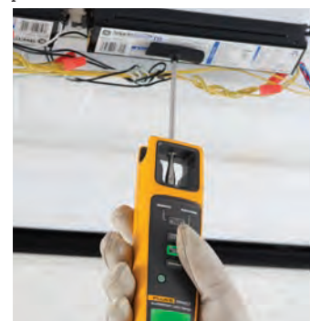
Snadné určení funkčnosti předřadníků.
