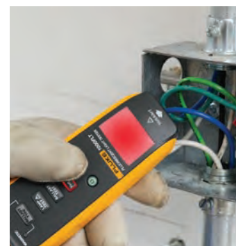
Rychlá kontrola na přítomnost napětí bez dotyku živého vodiče.
