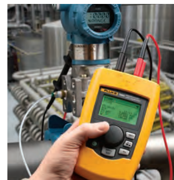
Kalibrátory smyčky Fluke jsou přesné a spolehlivé. 709H obsahuje navíc základní komunikaci prostřednictvím rozhraní HART (viz. str. 16).
