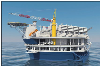
Obr. 1. Vizualizace plovoucí elektrárny – díky kulovitému tvaru trupu může být plavidlo dlouhodobě ukotveno na jednom místě a nemusí se natáčet po směru vln
