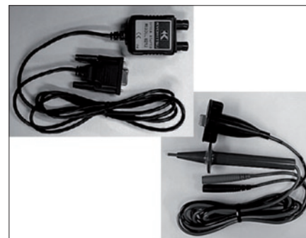
Obr. 8. Měřicí kabely a kabel pro optickou komunikaci s PC
