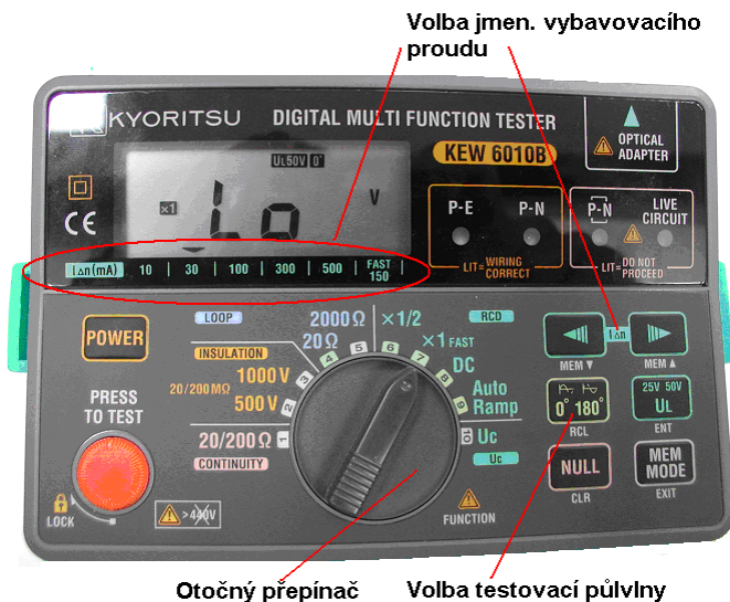
Obr. 5 Ovládání KEW 6010B při testu proudu. Chráníčů
