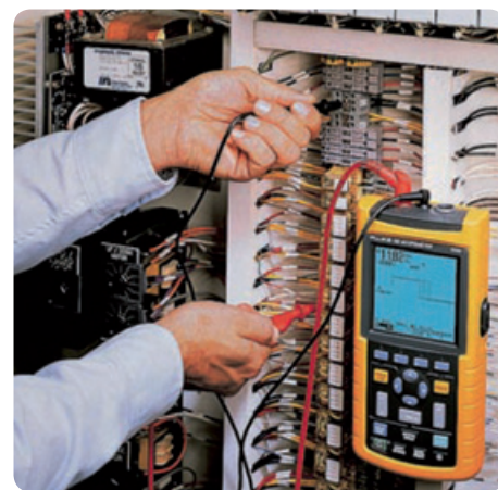
Obr. 2 Ověření případného svodu či přerušování
