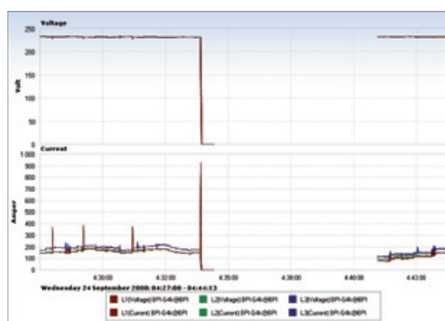
Obr. 5.c Detail výpadku 4:34 až 4:41 – Největší špička proudu z celého týdne, přesahuje 900 A, doba trvání cca 200 ms
